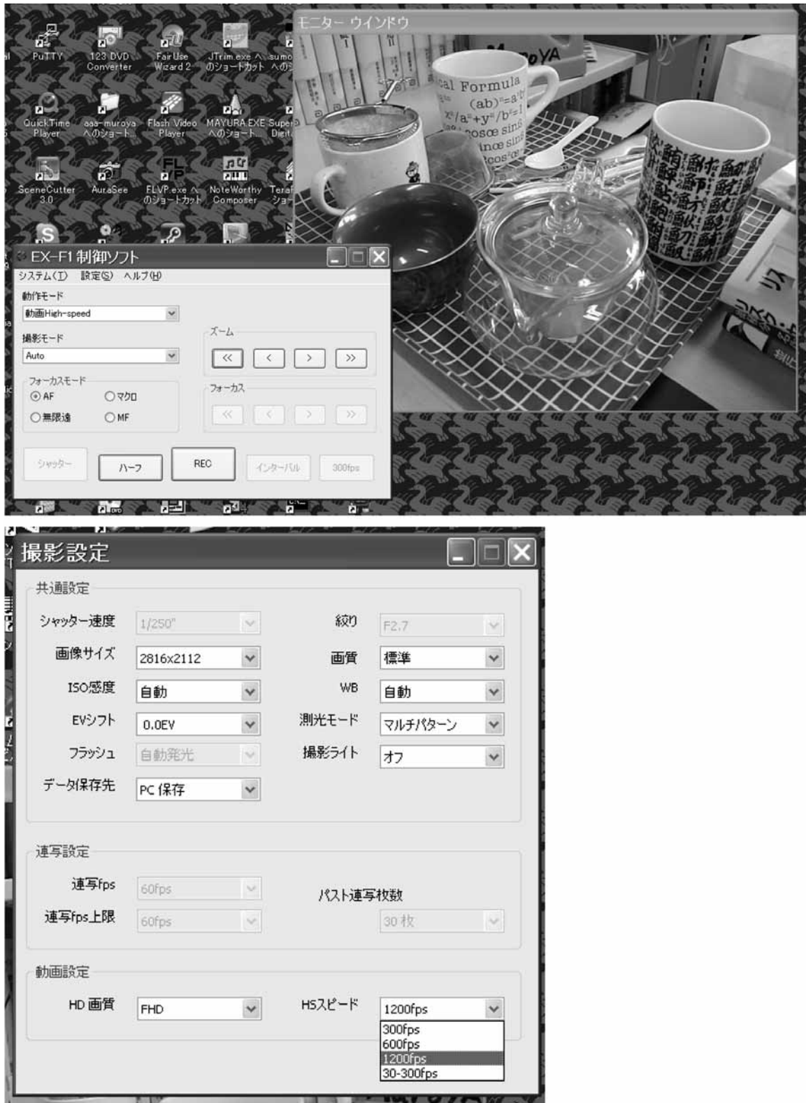
図6 パソコンによるコントロール画面、操作画面（上）と設定メニュー（下）。
