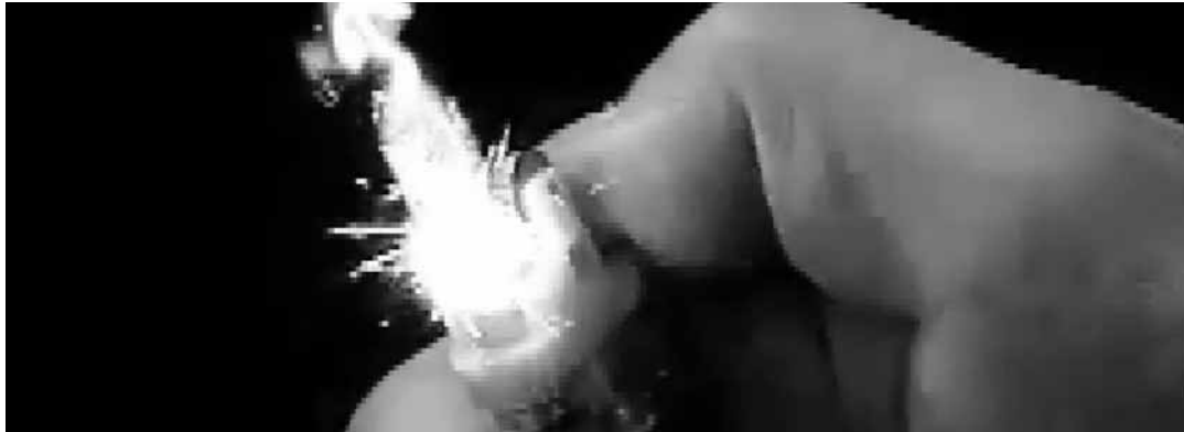
図3 ライターの着火の瞬間600fpsで撮影
