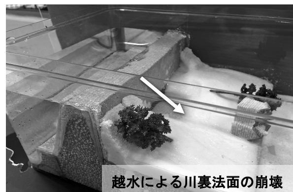
図4. 越水による川裏法面の崩壊
